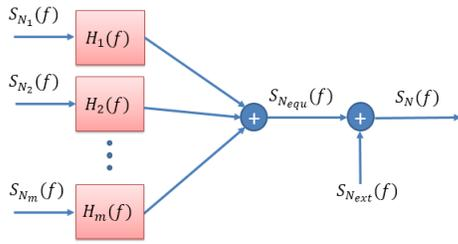
Figura 14. Esquema general del ruido en el receptor. Fuente: Los Autores
