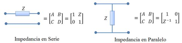
Figura 10. Matriz  $ABCD$  para una impedancia en serie o paralelo. Fuente: Los Autores
