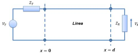
Figura 7. Línea de transmisión terminada. Fuente: Los Autores
