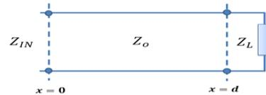
Figura 11. Traslación de impedancia en una sección al interior de una línea de transmisión. Fuente: Los Autores
