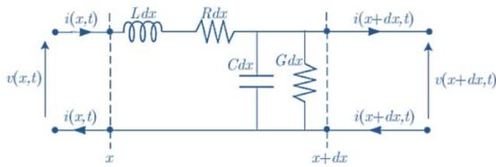
Figura 8. Representación diferencial de una línea de transmisión. Fuente: Los Autores
