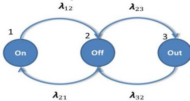
Figura 4. Modelo Markoviano Tri-estado para dispositivos eléctricos.
