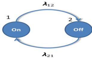
Figura3. Modelo Markoviano bi-estado para dispositivos eléctricos.
