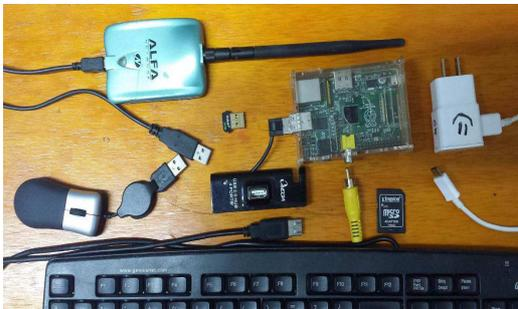
Fig. 17 kit para RaspBerry PI como computador
