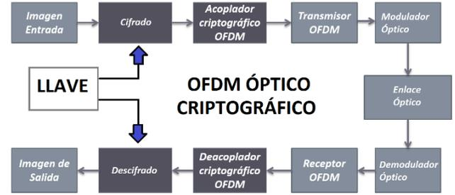
Figura 4. Diagrama de bloques del sistema de comunicación OFDM Óptico Criptográfico.
