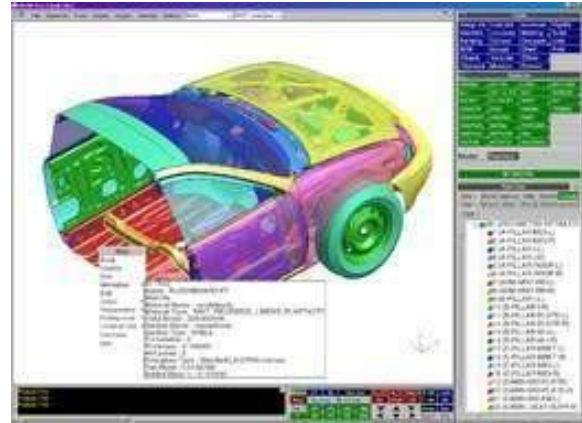
Figura 3. Ejemplo de aplicación de LS-DYNA en diseño automotriz [13].
