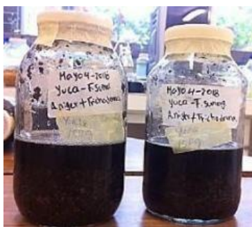
Figura 3. Biorreactores con fermentación sumergida.
