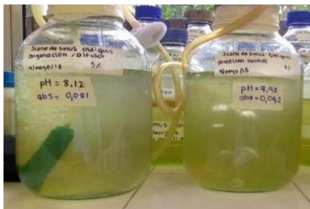
Figura 2. Fotobiorreactores en su orden de izquierda a derecha con difusor y con varilla de un solo orificio.
