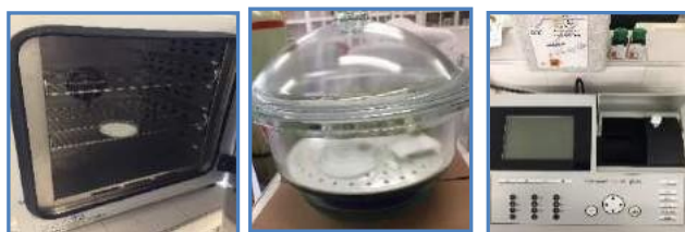
Figura 2. De izquierda a derecha se puede observar el horno con filtro, la cámara desecante y el espectrofotómetro pharo 300.
