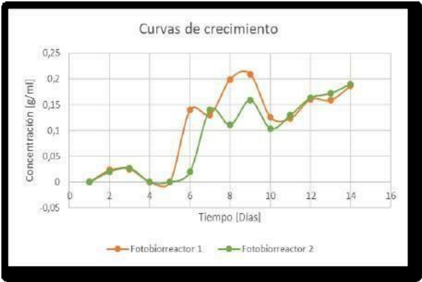
Figura 3. Curva de crecimiento de la cianobacteria del Fotobiorreactor 1 y 2 en Medio Zarrouk.
