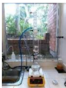
Figura 2. Método Soxhlet para determinación de grasas.
