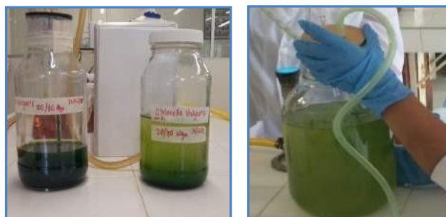
Figura 2. Fotobiorreactores de adaptación a la izquierda y de escalamiento a la derecha.
