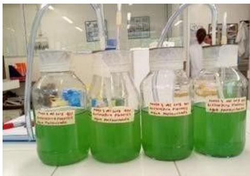
Figura 4. Fotobiorreactores-4 y 5, por duplicado.
