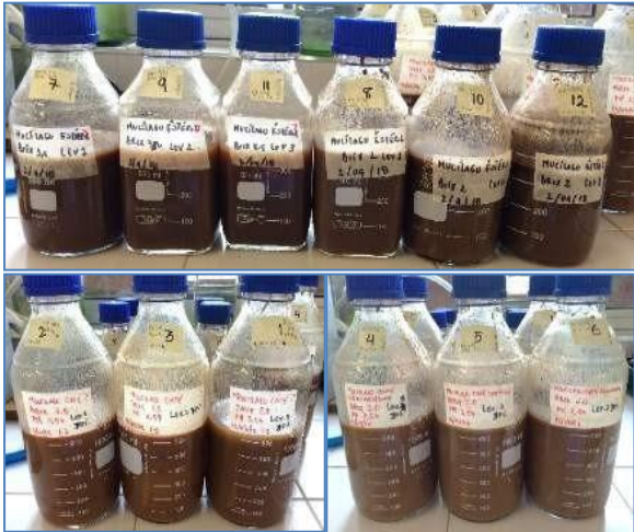
Figura 3. Biorreactores anoxigénicos estériles en la parte superior y no estériles en la inferior.
