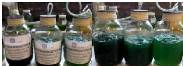
Figura 6. Fotobiorreactores aireados, con diferentes proporciones de agua residual domestica e inculo de Spirulina platensis . Fuente: Autores.
