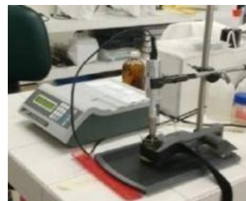
Figura 2. Ensayo de extracción de lípidos con ultrasonido. Fuente: Autores.
