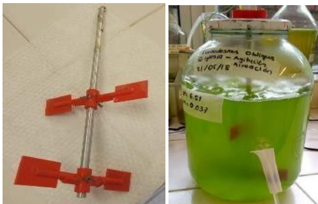
Figura 3. Foto biorreactor con aireación y movimiento por medio de aspas.
