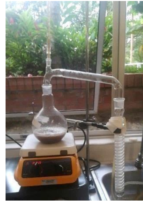
Figura 6. Producción de bioetanol por destilación simple.
