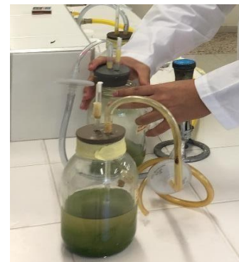
Figura 3. Montaje de fotobiorreactores con oxigenación.
