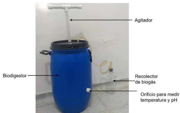
Figura 1. Partes del biodigestor.
