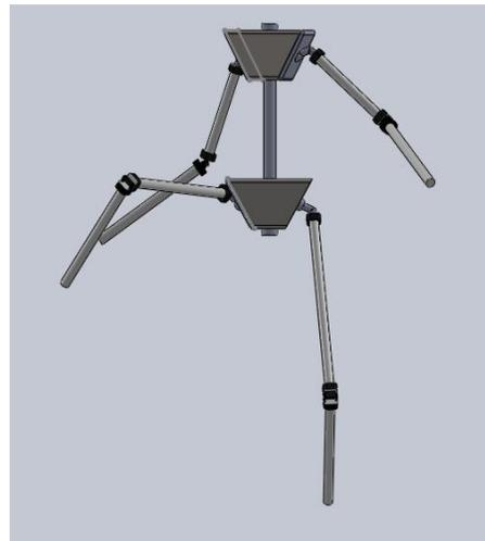
Figura 1 Esquema de la cadena cinemática propuesta
