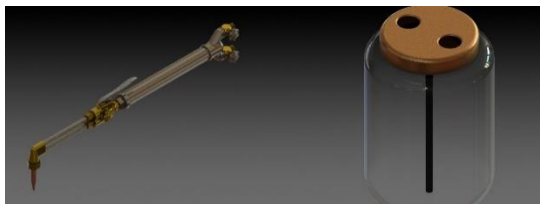
Figura 3. Diseño renderizado de los elementos complementarios. A la derecha el soplete y arrestallamas integrados, a la izquierda el burbujeador. Fuente: Autores
