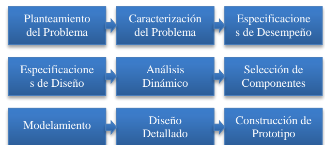
Figura 1. Metodología propuesta para el diseño y construcción de un vehículo baja SAE.
