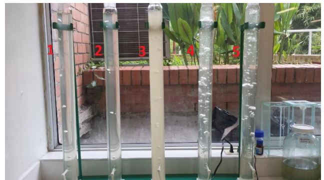
Figura 2. Observación del flujo de aire en fotobiorreactores
