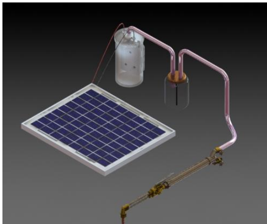
Figura 1. Diseño renderizado de la celda electrolítica y sus elementos complementarios. Fuente: Autores
